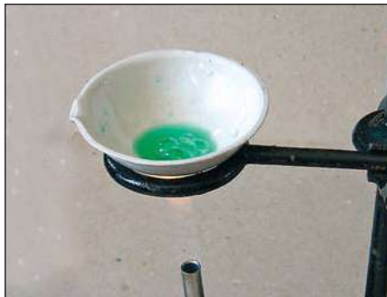
Мал. 21. Нагрівання рідини в порцеляновій чашці
