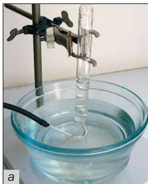
Мал. 66. Збирання кисню: а — витисненням води; б — витисненням повітря
