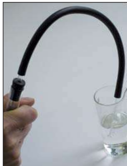
Мал. 69. Перевірка приладу на герметичність
