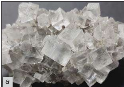
Мал. 34. Кристалічна (а) та аморфна (б) речовини: а — кам'яна сіль; б — скло
