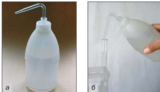
Мал. 8. Промивалка (а) і користування нею (б)
