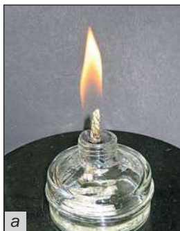
Мал. 12. Пристрої для нагрівання: а — спиртівка; б — гасіння полум'я ковпачком; в — газовий пальник
